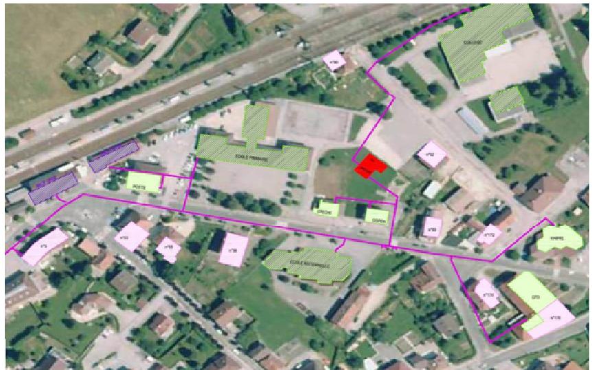
Le réseau de chaleur est long de 800m l
