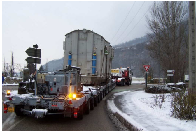
Transport routier des transformateurs
