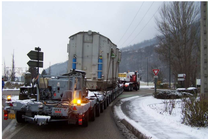
Transport routier des transformateurs
